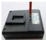
Schraube an der Rückseite lösen
