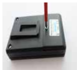
Batteriedeckel wieder einsetzen und Schraube gefühlvoll festdrehen, darauf achten, dass keine Kabel eingeklemmt werden.
