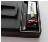
Batterie wieder Einsetzen, darauf achten, dass keine Kabel eingeklemmt werden.
